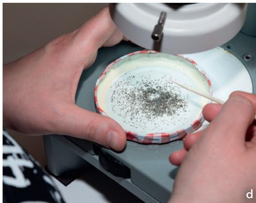
◀ Der »Dreck vom Dach« wird anschließend gereinigt (a), magnetisch getrennt (b) und gesiebt (c), dabei kann die Reihenfolge ja nach Situation variieren. Unter dem Auflichtmikroskop (d) schließlich wird das so vorbereitete Material weiter untersucht. Ungeübte sollten sich zunächst auf Vertreter der Gruppe der Barred Olivine mit ihrer typischen Oberflächenstruktur konzentrieren. Fotos: Peter Gärtner
