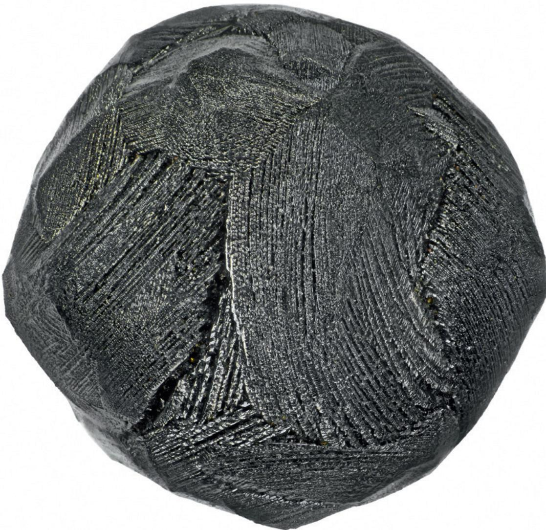
◀ *Der Mikrometeorit »Liertoppen« (NMM 1380) ist ein typischer Vertreter der eher unspektakulären Gruppe der Barred Olivine (BO), den mit Abstand häufigsten Mikrometeoriten. Gut zu sehen sind die Linien- und Balkenstrukturen, die auch für ungeübte Mikrometeoritenjäger unter dem Mikroskop leicht zu erkennen sind. Foto: Larsen/Kihle, mit freundlicher Genehmigung des Benevento-Verlags*
